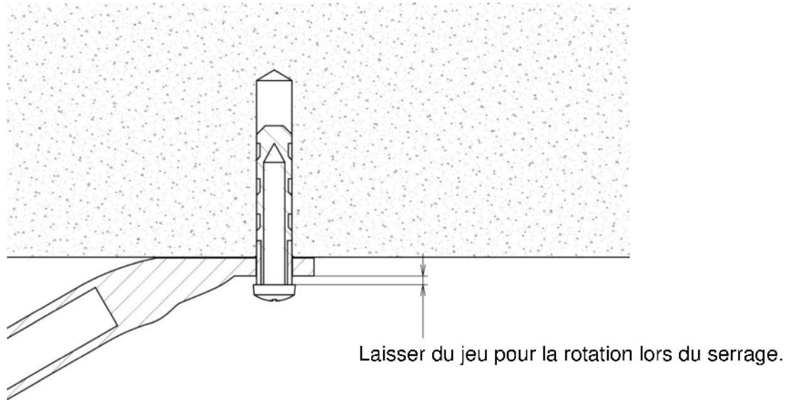
Refermer le volet manuellement et effectuer un réglage fin en desserrant la vis sans tête puis resserrer.
